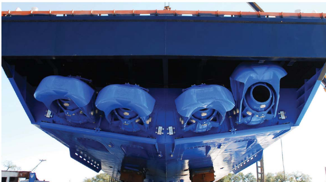
Судно снабжения "Aaron McCall" было первым судном с четырьмя водометами HamiltonJet HT900.
